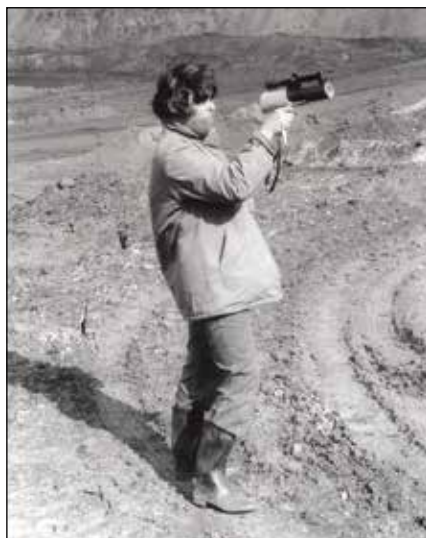
Zuzana Weishauptová při měření infračerveným teplověrem pro sledování ohnisek samovznícení na povrchovém dole, bez datace, foto autor neuveden ÚSMH AV ČR, osobní archiv Z. Weishauptové
