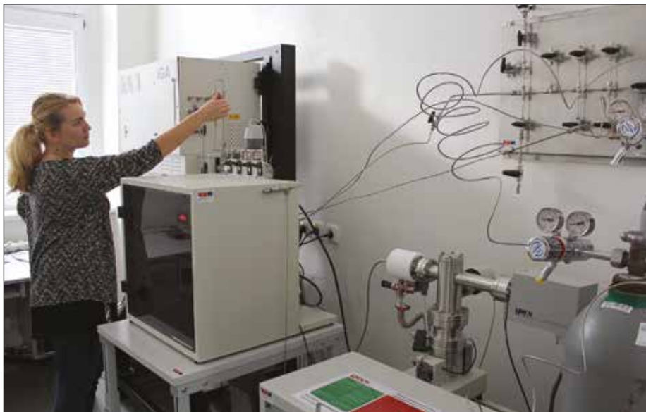
Gravimetrický sorpční analyzátor obsluhuje Maryna Vorokhta, rok 2018, foto Vlasta Mádlová
