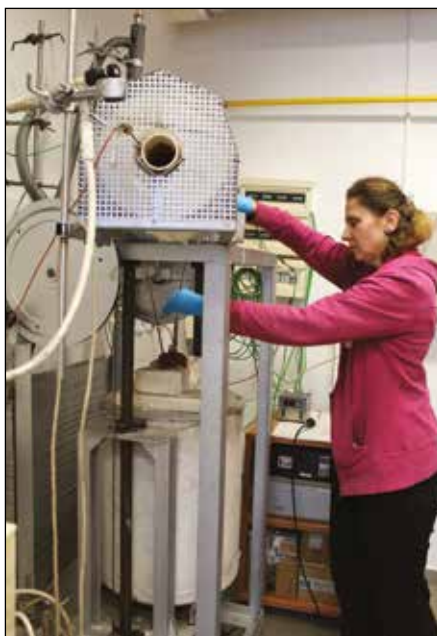
Olga Bičáková při sestavování aparatury pro tepelné zpracování organických odpadních materiálů. Pec se stacionárním ložem a druhým stupněm, rok 2018, foto Vlasta Mádllová
