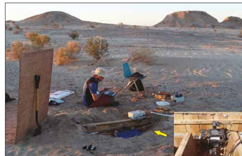
Kontrola dilatometru TM-71 s automatizovaným záznamem posunů na zlomu Superstition Hills na monitorovací stanici Imler v jižní Kalifornii, bez datace, foto Petra Štěpančíková ÚSMH AV ČR
