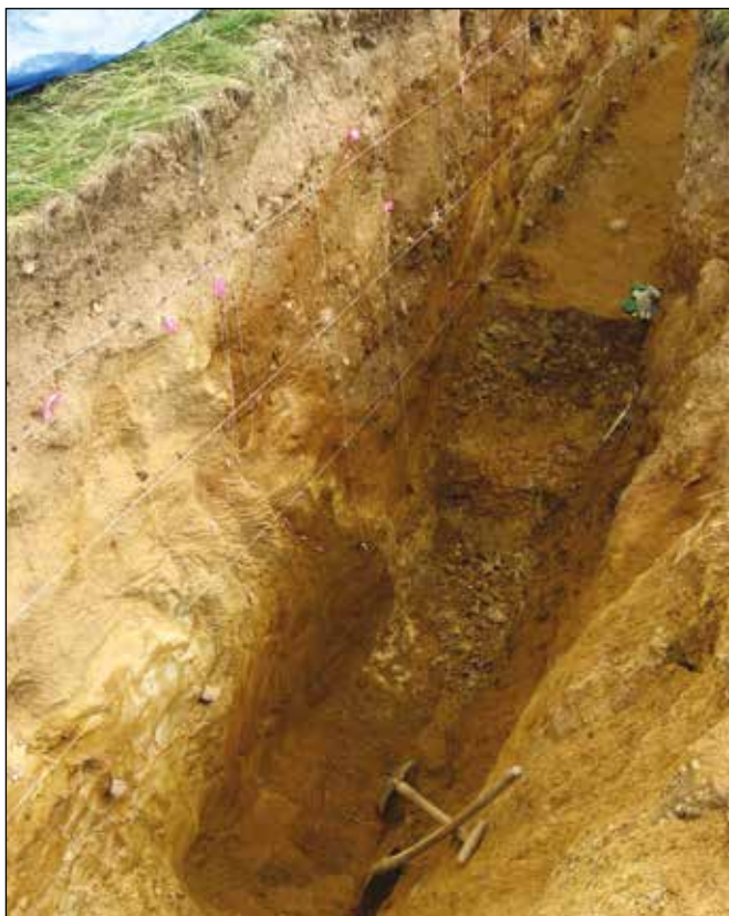
Deformace kvartérních sedimentů na mariánskolázeňském zlomu odkrytém v průzkumné paleoseismické rýze na lokalitě Kopanina na Chebsku, bez datace, foto Petra Štěpančíková ÚSMH AV ČR
