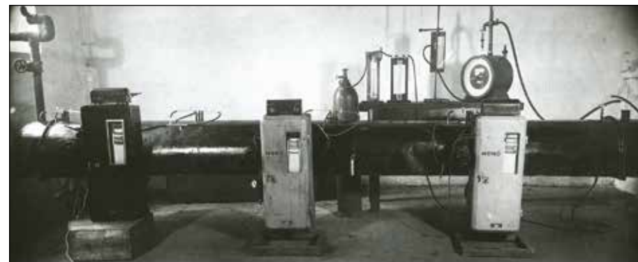
Studium difúze metanu a CO 2 bylo prováděno ve svislých válcích nebo ve vodorovné laboratorní štolě, plynové oddělení. Fotografie z výroční zprávy ústavu za rok 1952 NA, fond MPE, k. 110, inv. č. 84
