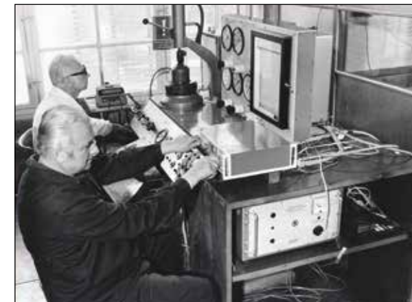
Zaměstnanci Hornického ústavu ČSAV Žampach a Polák – zkoušky hornin v triaxiálním přístroji při víceosé napjatosti, měření přetvárných charakteristik tenzometrickým způsobem, bez datace, foto Renáta Louvarová (Záběhlická) ÚSMH AV ČR, sbírka fotografií
