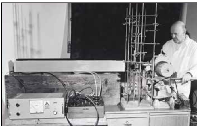
Modelová zařízení ke studiu kinetiky flotace v kombinaci se zdrojem laseru, na snímku František Dědek, bez datace, foto Renáta Louvarová (Záběhlická) ÚSMH AV ČR, sbírka fotografií
