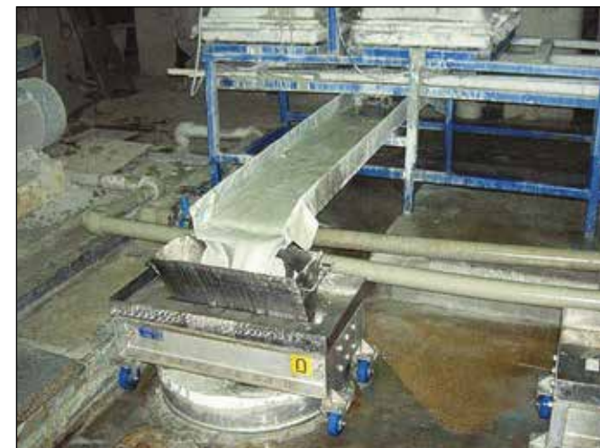
Provozní magnetický filtr v technologické lince přípravy keramické lící hmoty, bez datace, foto autor neuveden ÚSMH AV ČR
