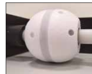
Zařízení 4SPIN (Contipro a.s.) je využíváno pro elektrostatické zvláknění polymerních roztoků, zejména polymerů přírodního původu, jako je kolagen, či pro pokryv implantátů (na snímku jsou jamky totální náhrady kyčelního kloubu)
