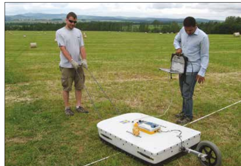
Geofyzikální měření georadarem na lokalitě Kopanina v Chebské pánvi za účelem zobrazení podpovrchových struktur okolo mariánskolázeňského zlomu, bez datace, foto Petra Štěpančíková ÚSMH AV ČR
