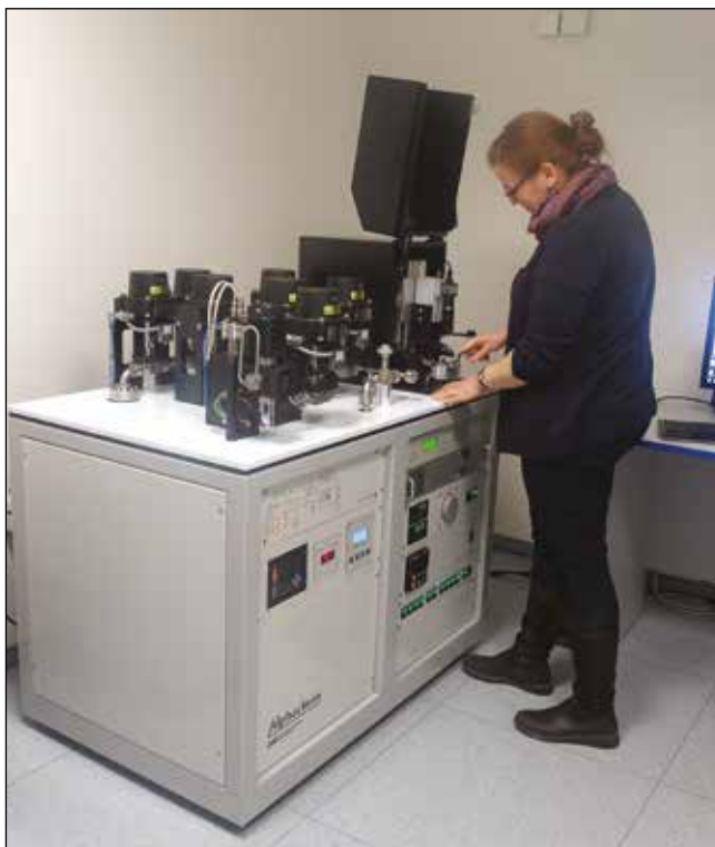
Hmotnostní spektrometr AlphachronTM určený pro heliovou termochronologii, který disponuje automatizovanou extrakcí radiogenního hélia a měřením jeho obsahu ve vzorcích minerálů, bez datace, foto Petra Štěpančíková ÚSMH AV ČR
