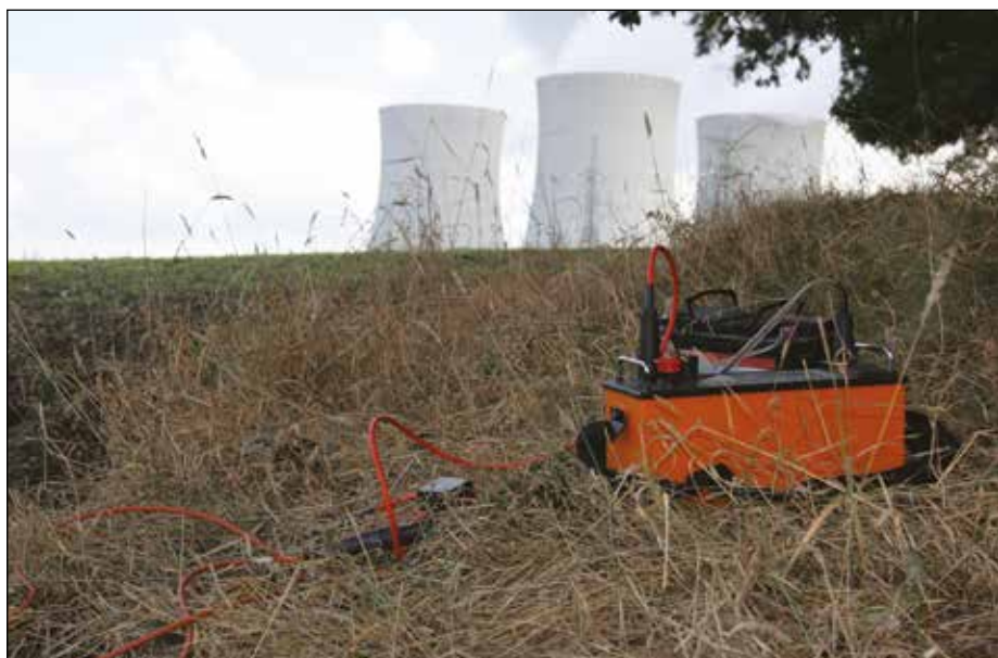
Získávání geoelektrických dat v okolí jaderné elektrárny Temelín, bez datace, foto autor neuveden ÚSMH AV ČR
