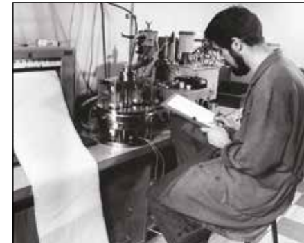
Petr Glogar při měření teplotní vodivosti vzorků hornin z příbramského uranového ložiska. Měření této veličiny bylo zásadní s ohledem na tepelnou výměnu (ohřev) důlního ovzduší na hlubokých patrech dolů, kde teplota horniny přesahovala 35°C, a bylo proto nezbytné důlní ovzduší nákladně chladit. Přístroj na měření teplotní vodivosti P. Glogar vyvinul a zkonstruoval. ÚSMH AV ČR, sbírka fotografií
