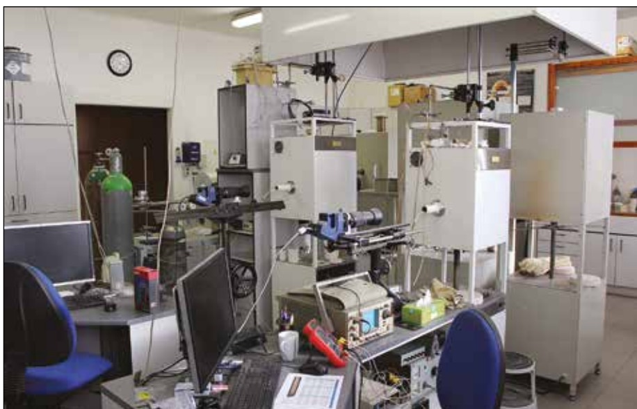
Laboratorní pece pro vysokoteplotní pozorování procesů ve sklovinách, rok 2018, foto Vlasta Mádlová
