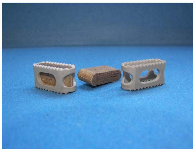
Obr. 3. Kompozitní výplně ( uprostřed) do mezitělových rozpěrek pro léčbu páteře na bázi vláknových kompozitů a nanočástic. Spolupráce s Medin Orthopaedics a.s., Praha
