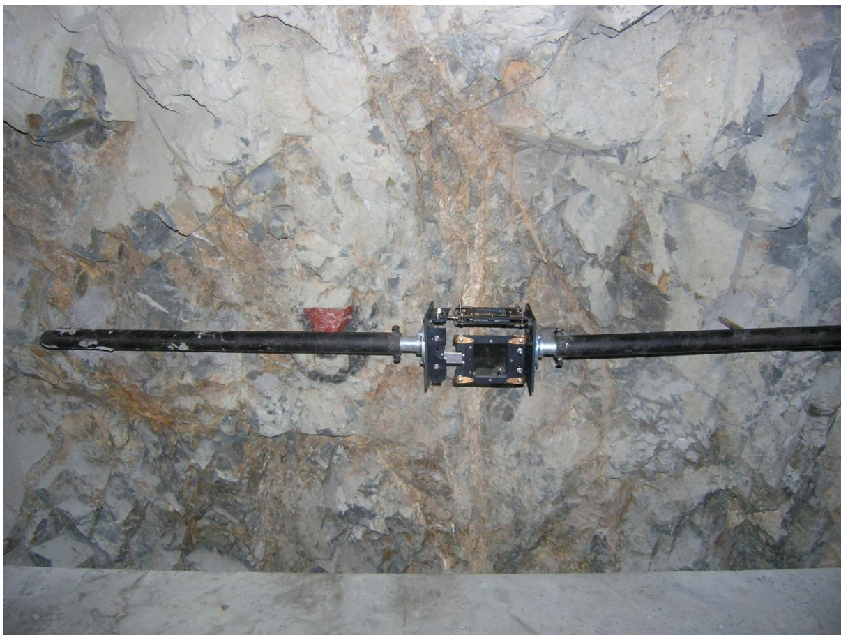
Foto 2: Presny 3D dilatometr české výroby, který je použit pro monitorování pohybu sesuvu.
