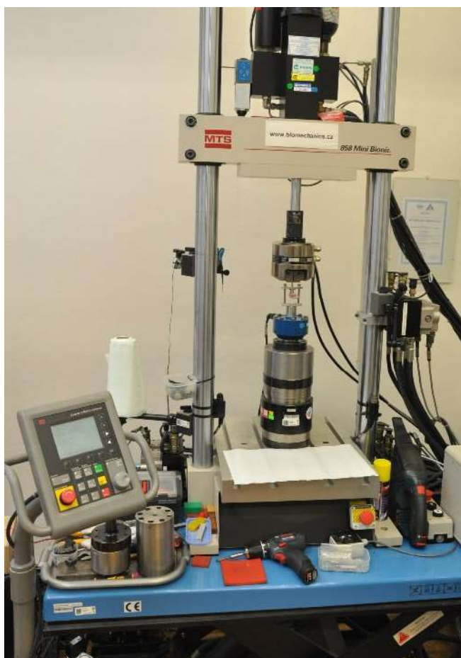
Obr. 1 Testovací systém MTS 858.2 Mini Bionix (MTS, USA) se speciálním přípravkem pro Pull-out testy (vlevo), detail kostního bločku v přípravku při vytahování implantátu (vpravo).
