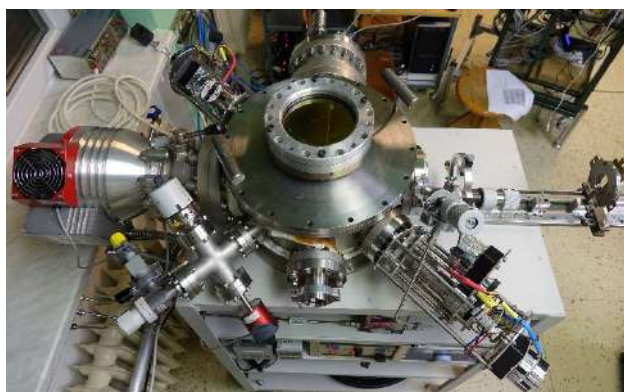
Obr. 2 Hybridní systémy pro přípravu dopovaných vrstev. Schéma depozičního systému PLD s magnetronovým naprašováním: 1 - Substrát, 2 - Grafitický terč, 3 - Laserový svazek, 4 - Magnetron, 5 - Záslepka magnetronu, 6 - Rotace, 7 - RF elektroda, 8 - Vakuová měřky, 9 - Turbomolekulární pumpa, 10 - Průtok plynu (argon/dusík/kyslík)
