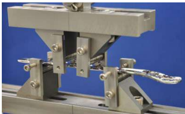
Obr. 1 Přípravek pro zkoušku čtyřbodovým ohybem spolu s ocelovou dlahou.
