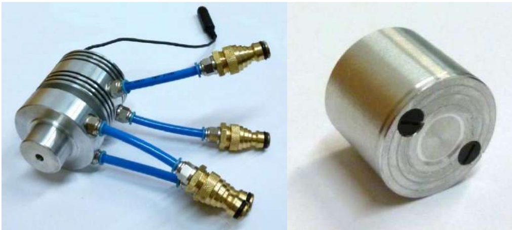
Obr. 1 Terčový systém chlazený vodou a vnitřní terč pro ozařování nanoprášku o hmotnosti 1,5 g.
