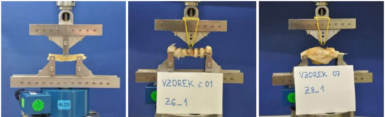
Obr. 1 Průběh zatěžování na speciálním přípravku pro tříbodový ohyb, vlevo – intaktní žebro, uprostřed – žebro fixované, vpravo – žebro nefixované
