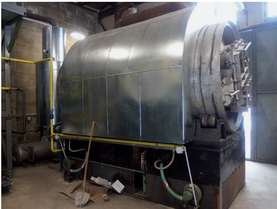
Rotační pec pro zpracování odpadního polyetyleny ve velkém měřítku
