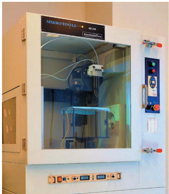
Obr. 10 Přístroj ELECTROSPUNRA 210 pro přípravu nanovláken
